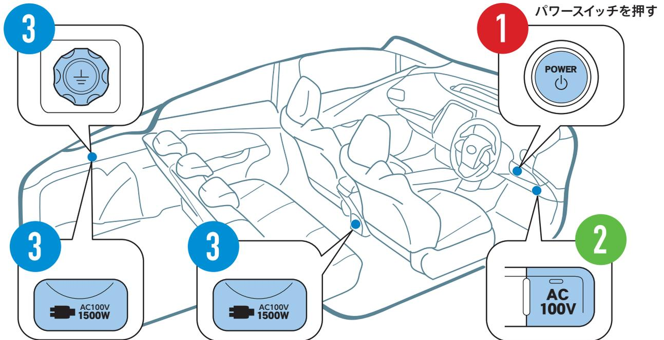
フタを開けて電気製品の電源プラグを差し込む
