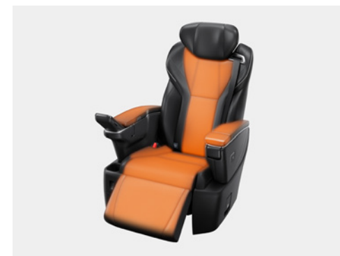
オレンジは、ヒーター加温箇所
