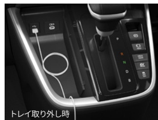
④シフト横小物入れ(充電用USB端子(Type-C)1個、通信/充電用USB端子(Type-C)1個付)
