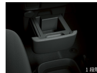
⑦2段階引き出し式センターホルダー (カップホルダー1個・小物入れ・カードホルダー)
