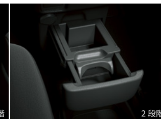
⑦2段階引き出し式センターホルダー (カップホルダー1個・小物入れ・カードホルダー)
