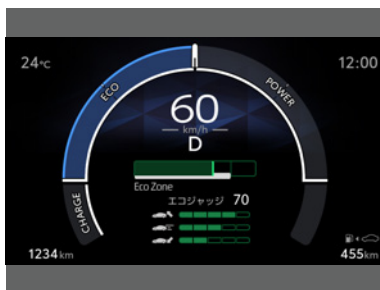
マルチインフォメーションディスプレイ表示例 (エコ採点 ※ハイブリッド車のみ)
