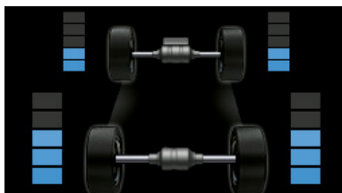
マルチインフォメーションディスプレイ内の前後輪トルク配分量表示
