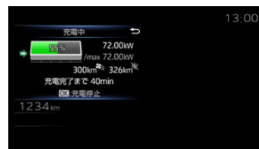
充電中のIG-OFF状態
