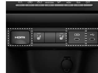
⑩HDMI入力端子 ①充電用USB端子 (Type-C) ②USB入力 (動画・音楽再生/給電 [Type-C])
