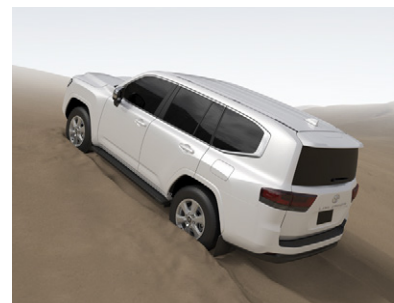
クロールコントロールシステムイメージ (スタック状態からの後退脱出)
