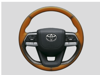
■ ヒーター加温箇所
