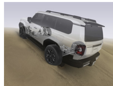
クロールコントロールシステム作動イメージ(スタック状態からの後退脱出)
