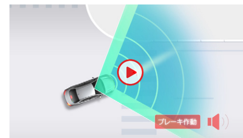
〔自車右左折時、対向方向から横断してきた歩行者も検知。〕
