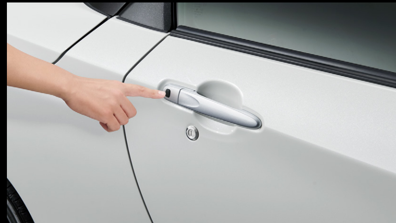
スイッチ操作でドアの施錠・解錠
