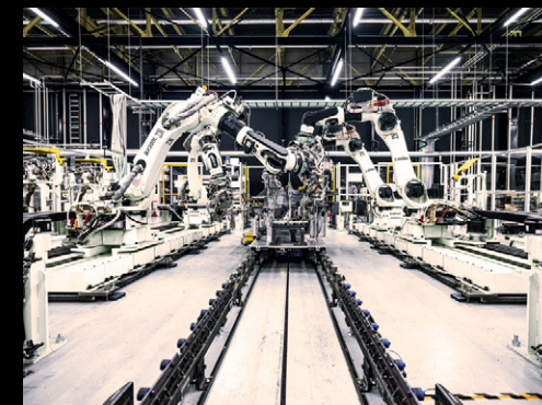
349点にスポット溶接の増し打ちを実施。 ■写真は当該車両とは異なります。
