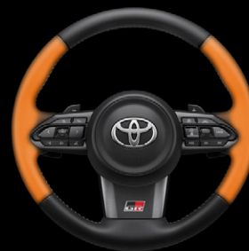
■オレンジはヒーター加温箇所
