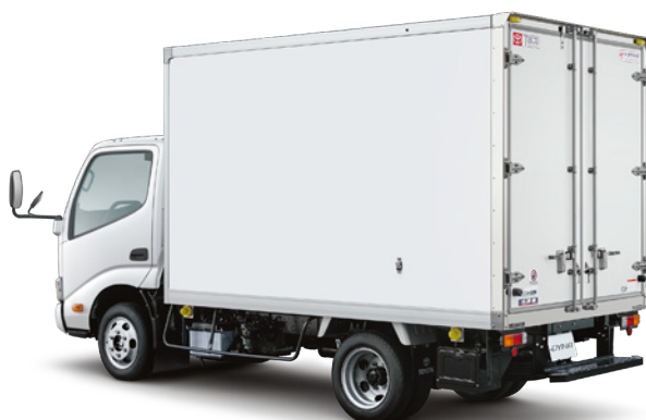
冷凍車(1ナンバークラス) 架装:〈トヨタ車体〉 冷凍機:〈デンソー〉
