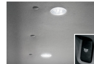
▶室内LED灯 (手元スイッチ付) シングルキャブ車 (“Sパッケージ”選択時)
