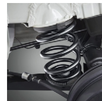
トレーリングリンク式 リヤコイルサスペンション
