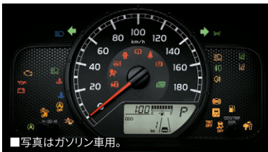
■写真はガソリン車用。 外気温 瞬間燃費 平均燃費 航続可能距離／ レーンディパーチャーアラート
