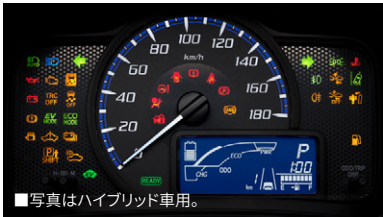
■写真はハイブリッド車用。 外気温 瞬間燃費 平均燃費 航続可能距離／ レーンディパーチャーアラート
