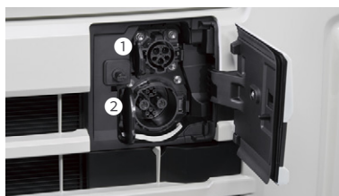
①普通充電インレット ②急速充電インレット(外部給電機能[V2H]付)
